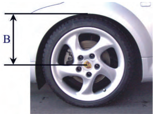
Abstandsmaß B - Radmitte - Kotflügelunterkante
